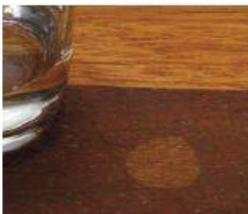
Door de geringe weerstand tegen oplosmiddel kunnen waterkringen ontstaan
